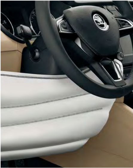
CEĻU ZONAS GAISA DROŠĪBAS SPILVENS Ceļu zonas gaisa drošības spilvens atrodas zem stūres kolonnas, un tas pasargā vadītāja ceļus un apakšstilbus.
