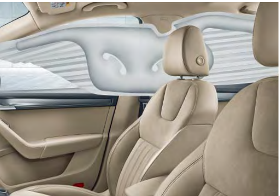
DROŠĪBAS AIZKARI Galvas gaisa drošības spilveni, kuri aktivizējoties izveido "aizkarus" gar logiem, pasargās gan priekšējo, gan aizmugurējo pasažieru galvas
