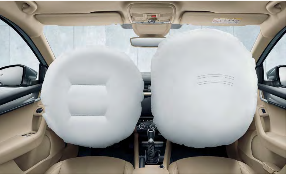
PRIEKŠĒJIE VADĪTĀJA UN PASAŽIERA GAISA DROŠĪBAS SPILVENI Vadītāja gaisa drošības spilvens atrodas stūrē, bet pasažiera - priekšējā panelī. Ja nepieciešams, pasažiera gaisa drošības spilvenu iespējams atslēgt, piemēram, ja uz priekšējā sēdekļa atrodas bērnu sēdekļītis.
