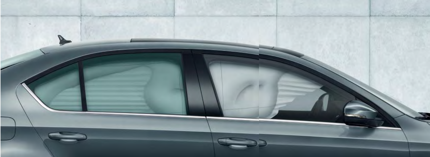
DROŠĪBAS AIZKARI Galvas gaisa drošības spilveni, kuri aktivizējoties izveido "aizkarus" gar logiem, pasargās gan priekšējo, gan aizmugurējo pasažieru galvas
