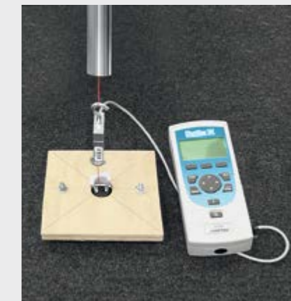
Stiprinājuma elementu spēka testēšana
